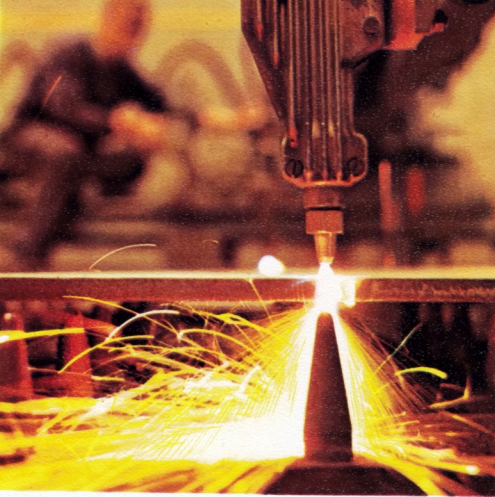
snijden platen DAF YP 408 pantservoertuig - schuurplaats in de cabine-lakstraat - afbouw op de truck-eindlijn
